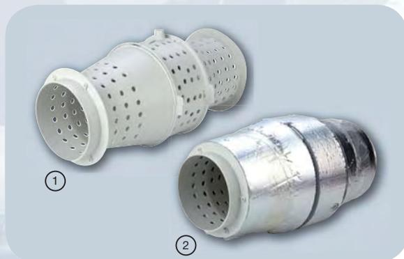
Звуковые волны проходят через внутренний перфорированный корпус вентилятора ① и гасятся слоем шумопоглощающего материала ②.
