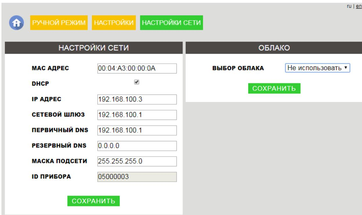
Рисунок 14. Отключение передачи данных в облако из Web-интерфейса
